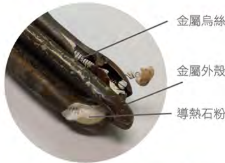
傳統不鏽鋼電熱管爆裂實體圖
